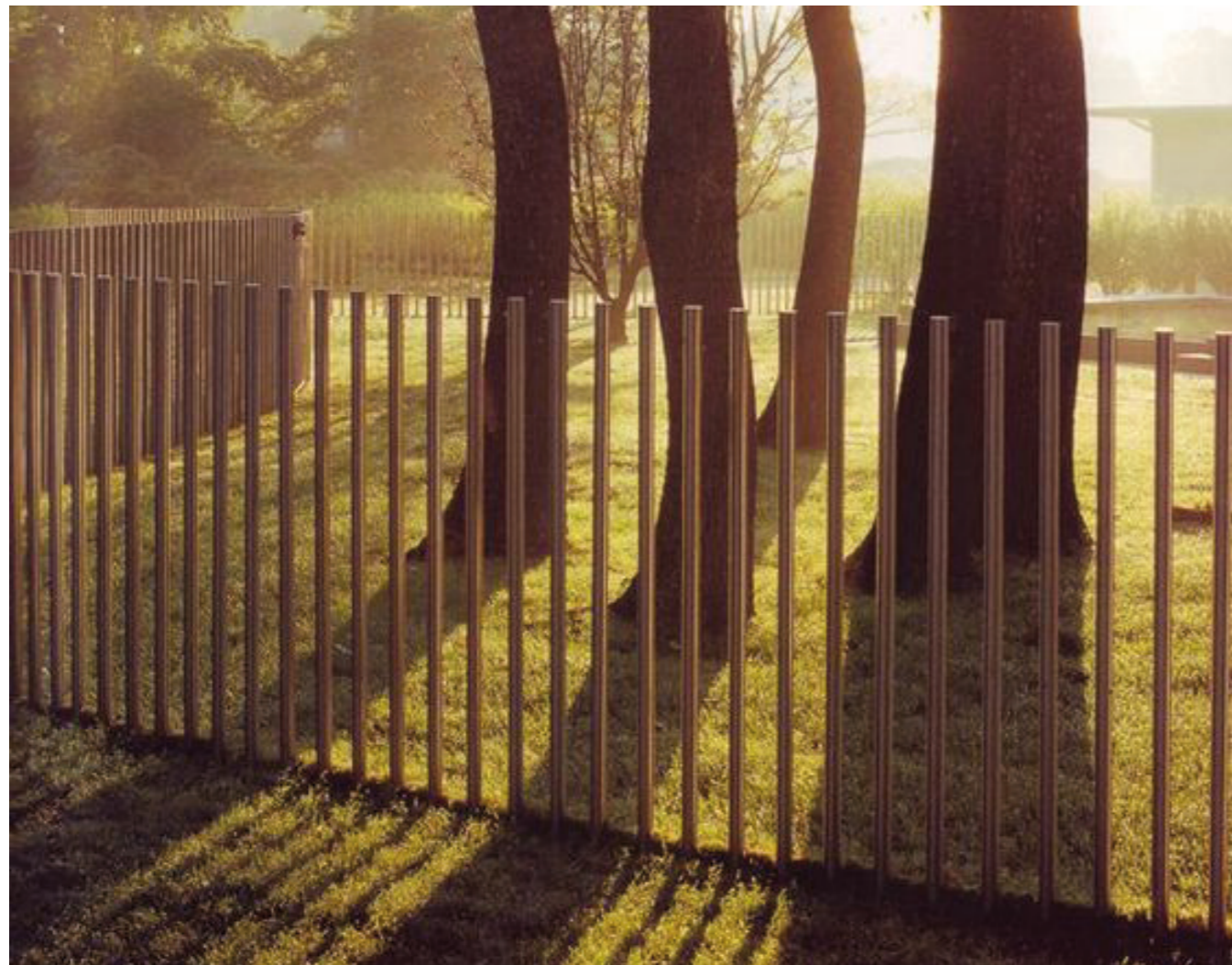
Exemple de clôture à barreaudage simple sans lisse supérieure
